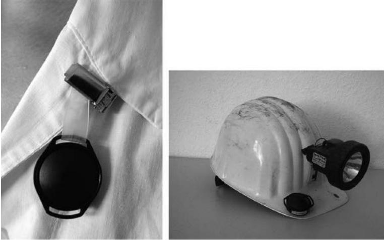
**Bild 8.30** Radonexosimeter, Typ Altrac B97 (Bildquelle: LPS-Personendosismessstelle/ALTRAC Radon-Prüflabor)
