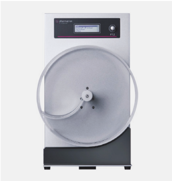
◉ Abb. 9.8 Abriebtester gemäß Ph. Eur. (SOTAX Group)
