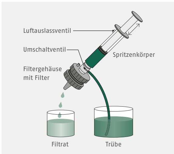
● Abb. 2.24 Filtration kleiner Chargen mittels Spritzenvorsatzfilter
